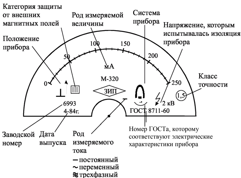
Рисунок 6.2 – Пример лицевой панели электрического измерительного прибора
