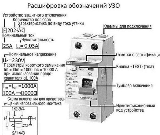
Рисунок А.9 – Пример маркировки УЗО
