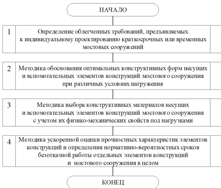
Рисунок 4 – Укрупненная блок-схема алгоритма проектирования сборно-разборного краткосрочного (временного) моста из местных материалов
