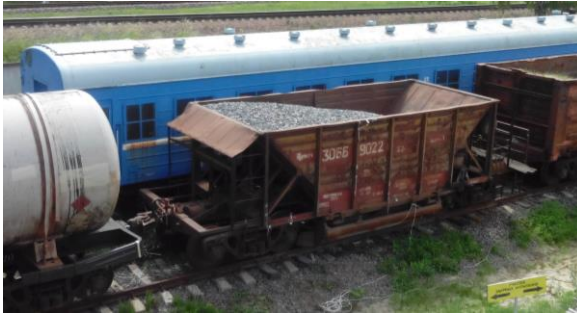
Рисунок 3. – Испытание вагона хоппер-дозатора при соударении
