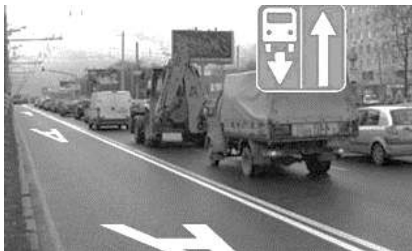
Рисунок 2 – Организация выделенной полосы, против движения общего ТП
