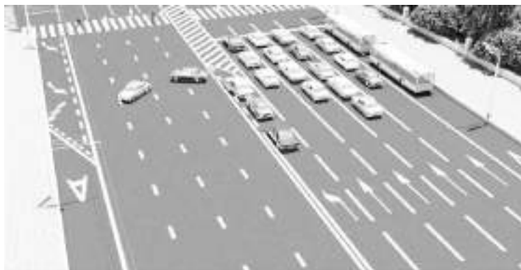
Рисунок 1 – Организация выделенной полосы, справа по ходу движения ТП
