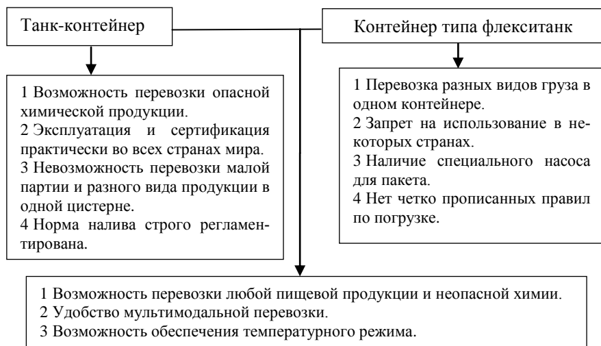
Рисунок 2 – Схема сравнительных характеристик при использовании танк-контейнеров и контейнеров типа флекситанк при перевозках с участием железнодорожного транспорта
