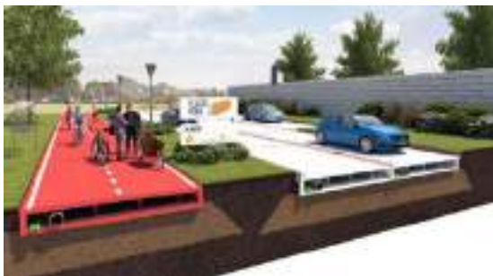
Рисунок 3 – Дорожное полотно из литых панелей
