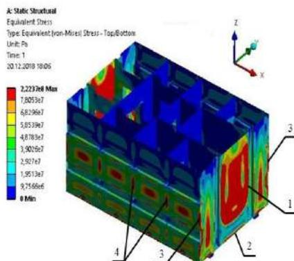
Рисунок 2 – Распределение эквивалентных напряжений по Мизесу в конструкции цистерны пожарного автомобиля на шасси МАЗ-6317: 1 – угловое сварное соединение пенобака к передней стенке; 2 – угловое сварное соединение нижней и передней стенки; 3 – угловое сварное соединение передней и боковых стенок; 4 – угловое сварное соединение поперечных волноломов к боковым стенкам
