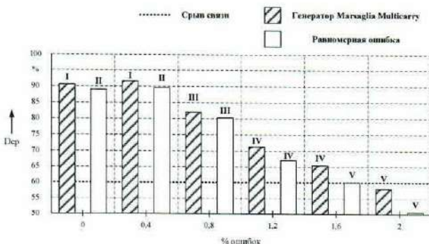
Рисунок 2 – Зависимость значений звуковой артикуляции ( D ) от процента ошибок методами генератора и равномерной ошибки при исследовании на переезде
