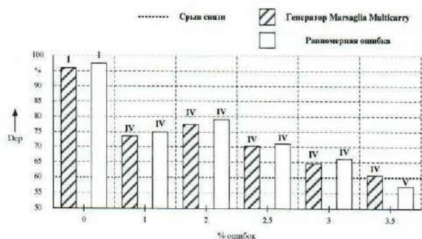
Рисунок 1 – Зависимость значений звуковой артикуляции ( D ) от процента ошибок методами генератора и равномерной ошибки при исследовании на станции
