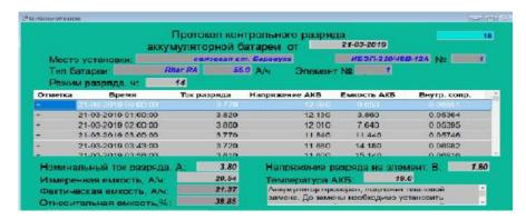
Рисунок 2 – Скриншот протокола учета контрольного разряда АКБ
