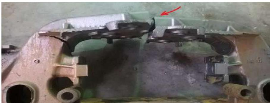
Рисунок 3 – Излом боковой рамы
