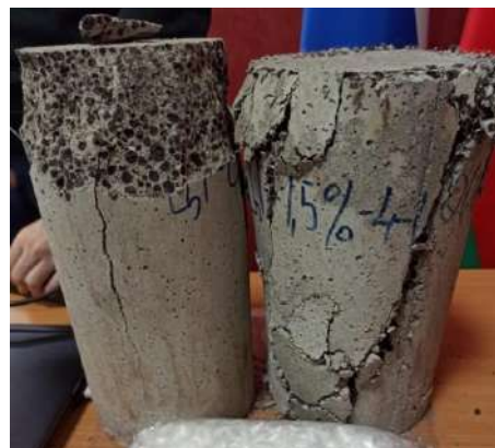
Рисунок 1 – Характер разрушения опытного цилиндра из керамзитобетона, армированного полипропиленовой фиброй (справа)
