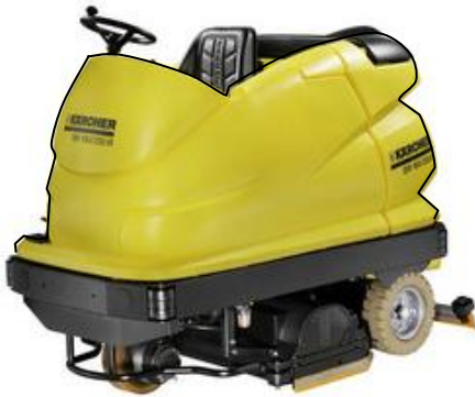
Рисунок 4.20 – Поломоечная машина Karcher (Керхер) BR 100/250 R Вр Pack
