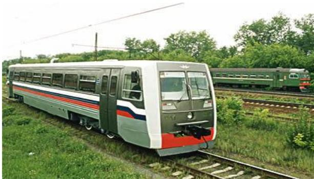
совый автобус РА-1 (модель 731), показанный на рисунке 3. В данной конструкции использован двигатель – дизель MTU 6R 183 TD13H (EURO II) мощностью 428 л.с., расположенный между тележками. Диаметр колес по кругу катания – 860 мм. Вместимость – до 100 человек, конструктивная скорость – 80 км/ч. Данная модель рельсового автобуса может эффективно использоваться на малодеятельных линиях Белорусской железной дороги, количество которых на сегодняшний день составляет 12 участков.
