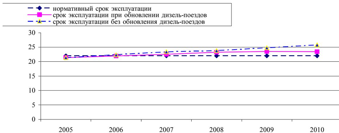
Рисунок 1 – Диаграмма прогнозирования срока эксплуатации дизель-поездов
