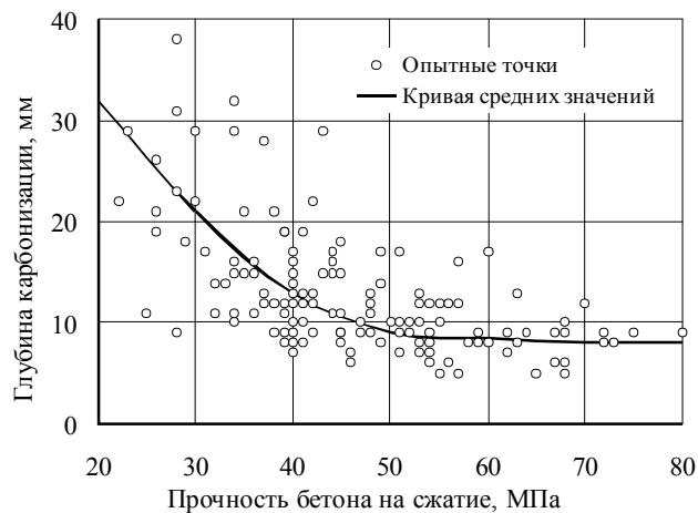
Рисунок 7 – Зависимость глубины карбонизации бетона от его прочности на сжатие (по данным С.Н. Алексеева и Н.К. Розенталя)
