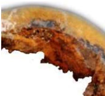
Рисунок 1 – Графитовая коррозия металлических труб
