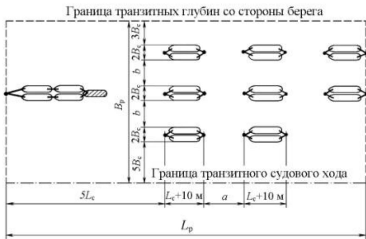
Рисунок 8.2 – Расчетная схема для определения площади сортировочного рейда с аванрейдом
