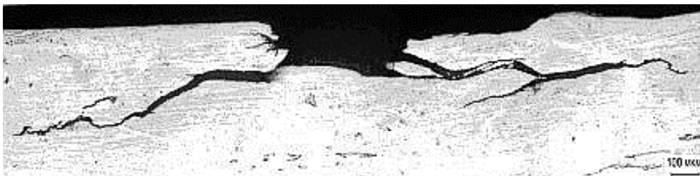
Рисунок 13 – Усталостное поверхностное контактное повреждение поверхности катания рельса из прямого участка
