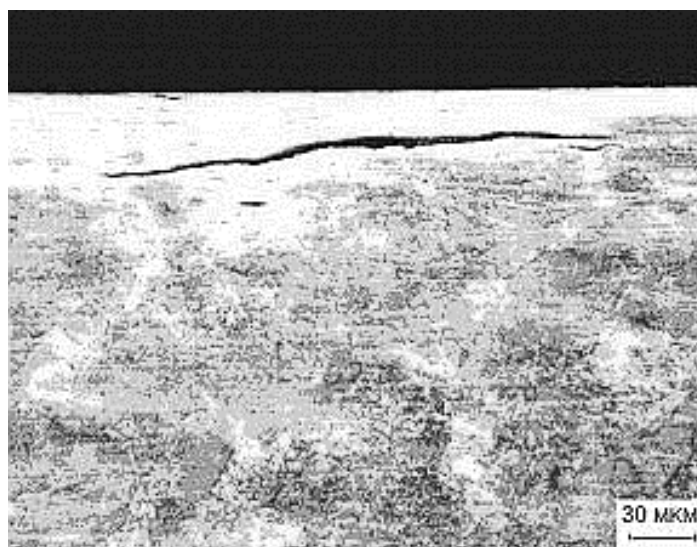
Рисунок 14 – Подповерхностная усталостная трещина
