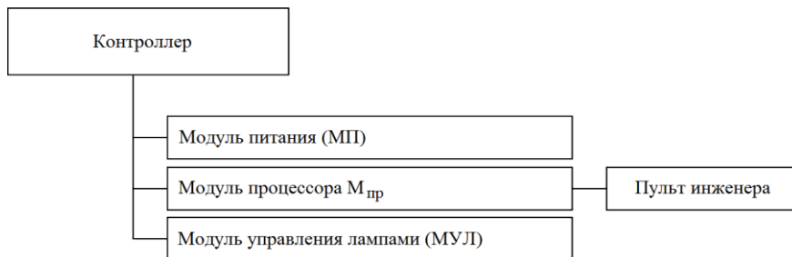
Рисунок 3.29 – Структурная схема дорожного контроллера «ДУМКА»
