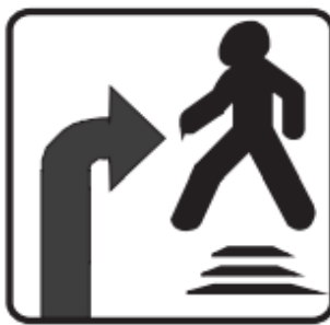
Рисунок 3.74 – Дополнительное оборудование, применяемое в случаях, когда предусматривается движение правоповоротного транспортного потока, регулируемое дополнительной секцией, одновременно с пешеходным потоком через проезжую часть, на которую выполняется конфликтный поворот: а – информационная секция ИС.1.п; б – информационная табличка ИТ.1.п
