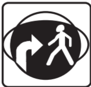
Рисунок 3.74 – Дополнительное оборудование, применяемое в случаях, когда предусматривается движение правоповоротного транспортного потока, регулируемое дополнительной секцией, одновременно с пешеходным потоком через проезжую часть, на которую выполняется конфликтный поворот: а – информационная секция ИС.1.п; б – информационная табличка ИТ.1.п
