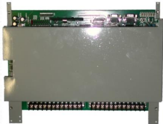
Рисунок 3.32 – Контроллер «ДУМКА» в настенном варианте (моноплатный принцип построения)
