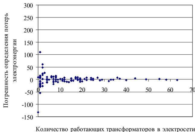
Рисунок 1 – Зависимость погрешности определения потерь энергии в сети по выражению (3) от количества работающих в этой сети трансформаторов
