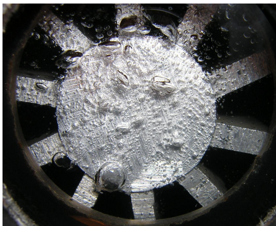
Развитое кипение при 40 < q < 63 кВт/м 2
