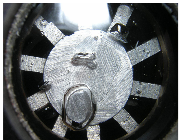
Неразвитое кипение при 10 < q < 20 кВт/м 2
