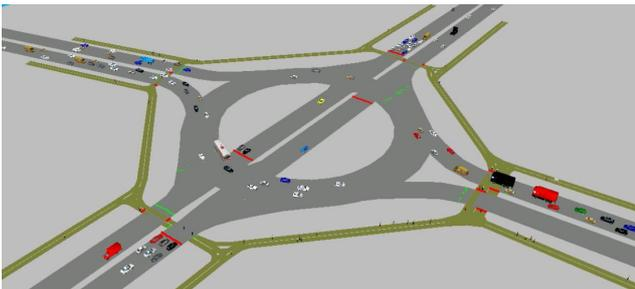
Рисунок 10 – Движение транспортно-пешеходных потоков при разрезе центрального островка вдоль высоконагруженной магистрали
