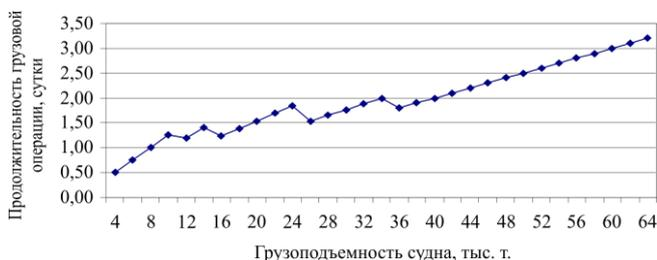
Рисунок 2 – График зависимости нормативной продолжительности грузовой операции от грузоподъемности судна
