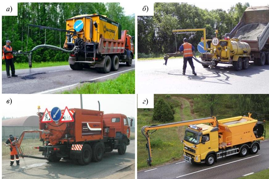
Рисунок 2.4 – Установки для ликвидации ямочности по струйно-инъекционной технологии:
