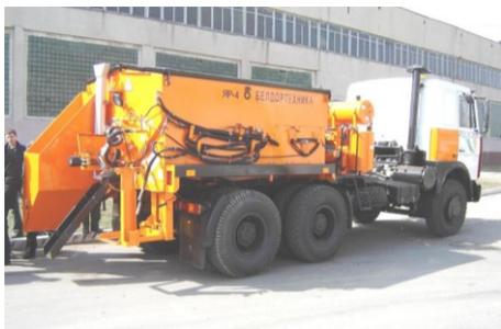
Рисунок 2.2 – Установка ЯР-4 на шасси МАЗ-6303А5
