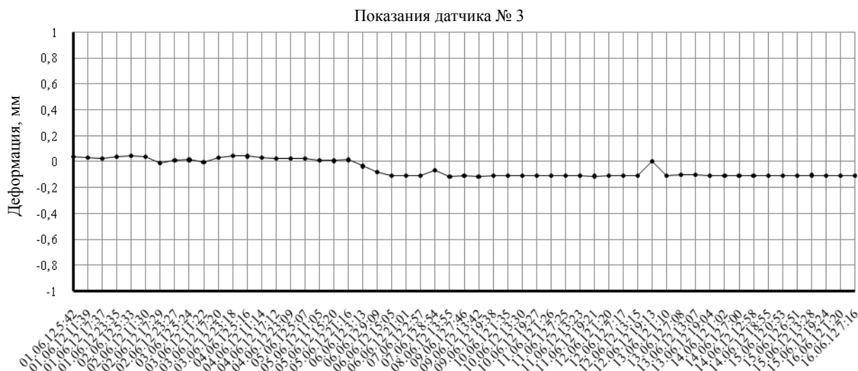
Рисунок 11 – Данные наблюдений за состоянием трещины датчиком № 3
