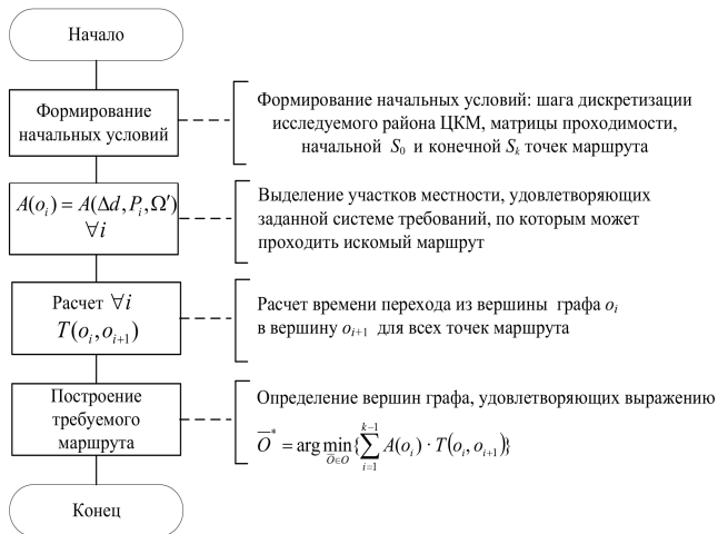
Рисунок 4 – Схема алгоритма поиска маршрута, обеспечивающего наименьшее время движения из начальной точки S_0 в конечную S_k
