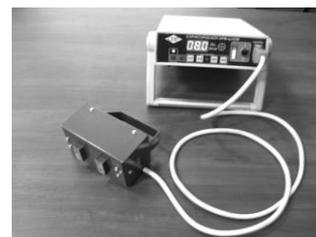
Рисунок 3 – Внешний вид применяемого при контроле металла цистерн структуроскопа
