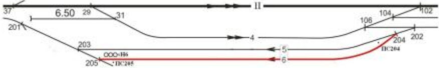
Рисунок 3.7 – Укладка путей второй горловины через приемоотправочный путь с минимальной полезной длиной
