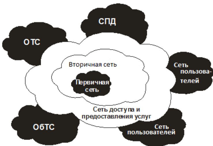
Рисунок 8.2 – Архитектура цифровой сети связи: ОТС – оперативно-технологическая связь; ОбТС – общеслужебная телефонная связь; СПД – сеть передачи данных
