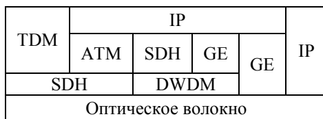
Рисунок 6.2 – Вариант архитектуры интегрированной мультисервисной перспективной IP-сети
