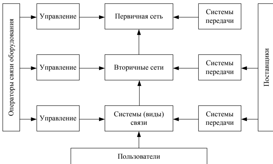
Рисунок 8.1 – Архитектура сети связи железной дороги
