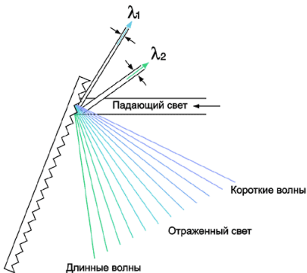
Рисунок 7.7 – Отражение составного сигнала дифракционной решеткой
