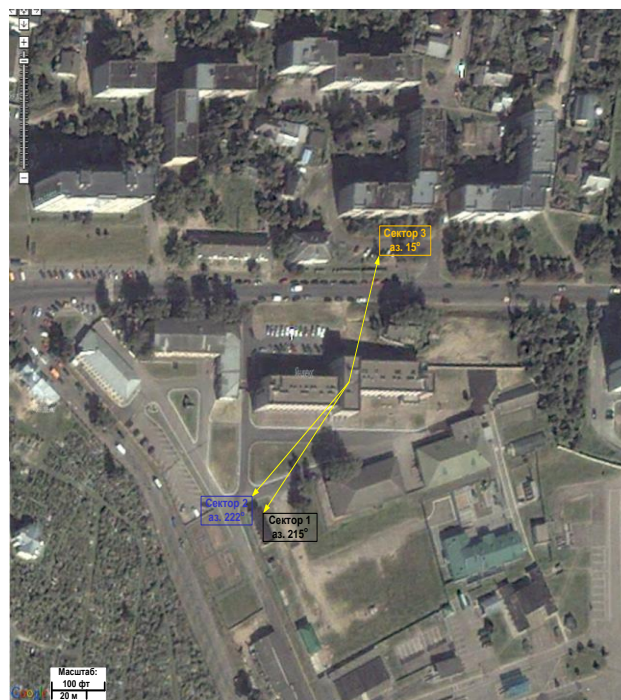
Рисунок 3 – Азимуты излучения для точек доступа
