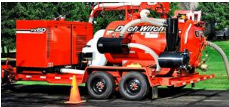
Рисунок 6.32 – Вакуумный экскаватор модели FX30 в прицепном варианте
