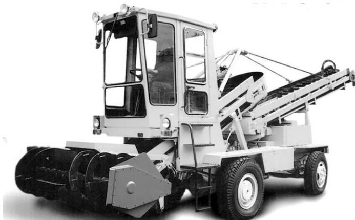
Рисунок 7.32 – Погрузчик Амкодор-37 (ТМ-3-02) с фрезерным питателем
