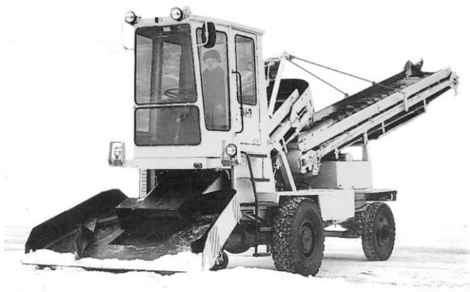
Рисунок 7.29 – Погрузчик Амкодор-37 (ТМ-3-01) с лаповым питателем
