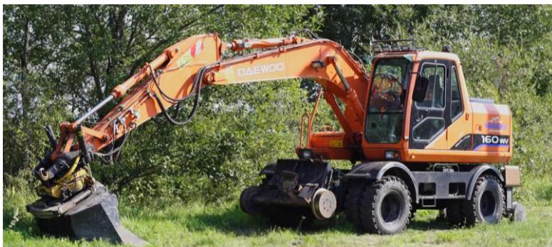
Рисунок 1.23 – Гидравлический одноковшовый экскаватор на комбинированном ходу
