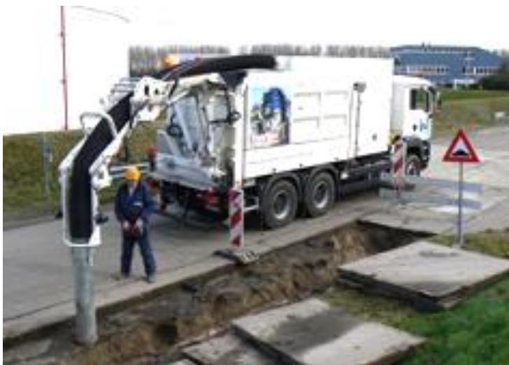
Рисунок 6.33 – Вакуумный самоходный экскаватор модели Dino 3
