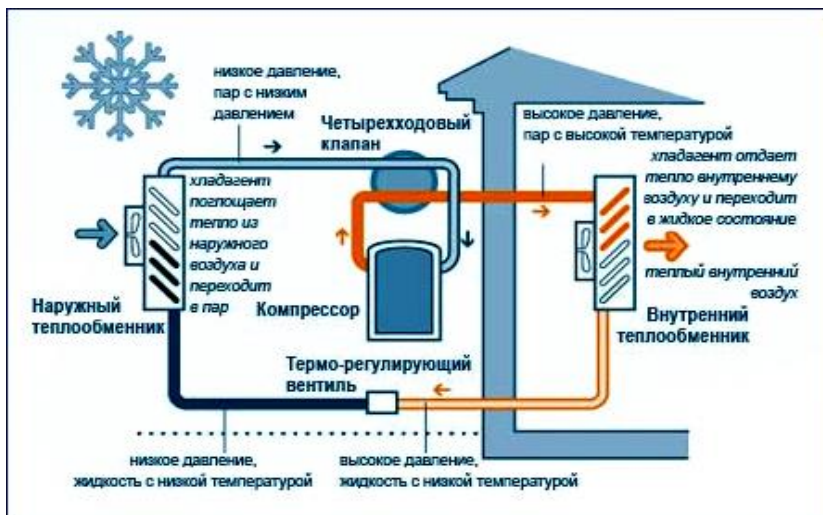
Рисунок 90 – Схема работы воздушного теплового насоса ( http://www.ecogroup.com.ua/spravochnik/vse-o-teplovykh-nasosakh/vozdushnyi-teplovoi-nasos )
