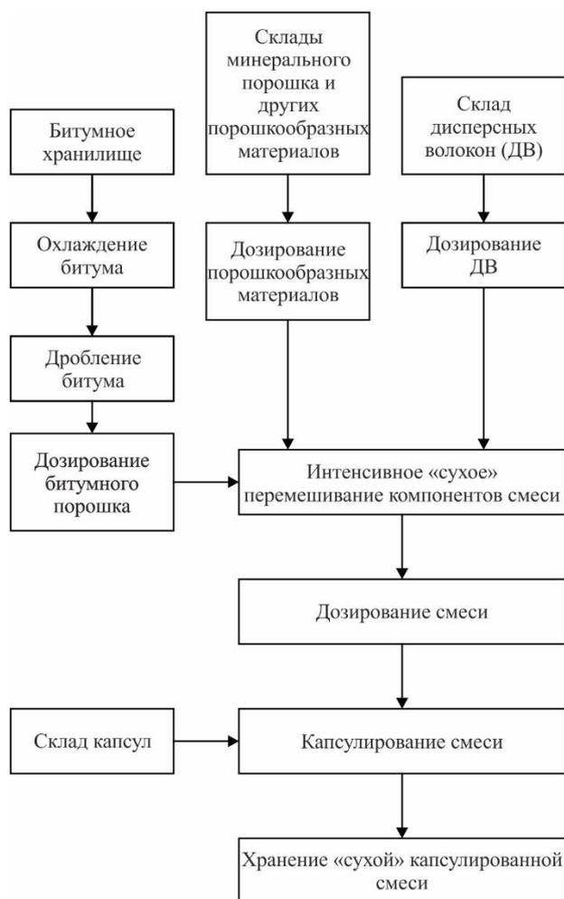
Рисунок 2 – Варианты технологии капсулирования органического вяжущего
