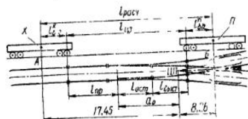
Рис. 5.16. Схема расчета минимального расстояния между отцепами на стрелочном переводе
