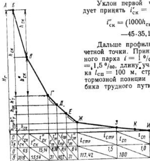
Рис. 5.9. Схема профиля спускной части горки
