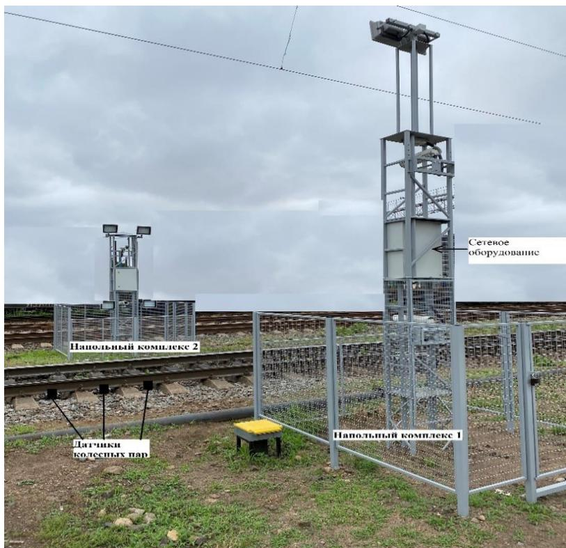
Рисунок 1 – Внешний вид напольных комплексов 1 и 2 «СТЗ.ИНВ»
