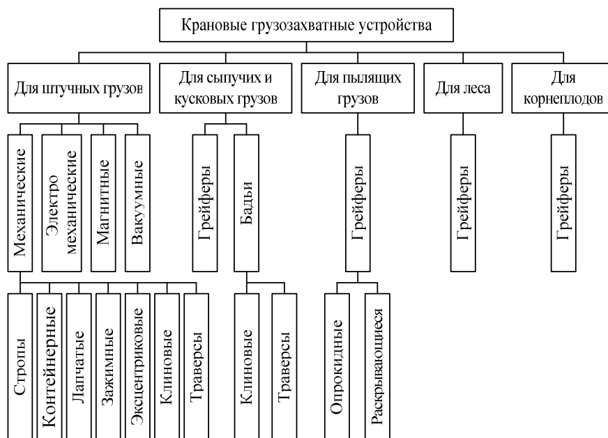
Рисунок 4.65 – Классификация крановых грузозахватных устройств по назначению и принципу действия
