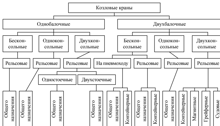
Рисунок 4.11 – Классификация козловых кранов
