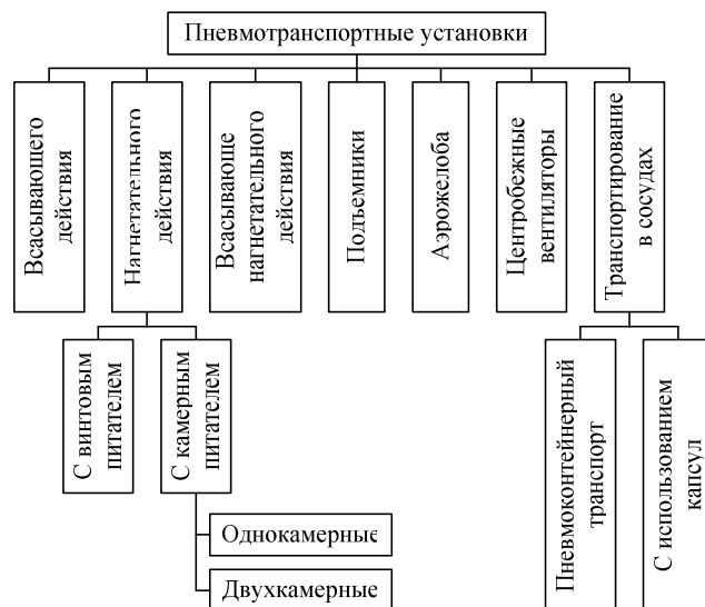
Рисунок 3.1 – Классификация пневмотранспортных установок
