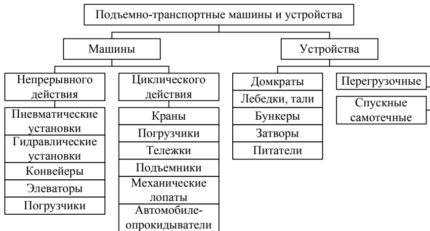
Рисунок 2.1 – Классификация подъемно-транспортных машин и устройств
