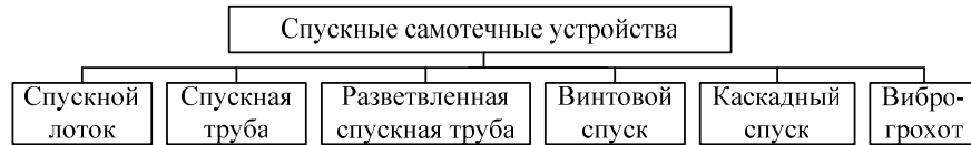
Рисунок 5.24 – Классификация спусковых самотечных устройств
