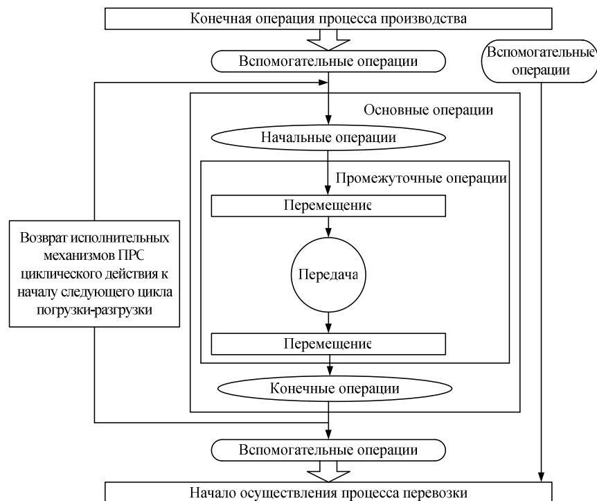
Рисунок 7.1 – Общая структура технологического процесса погрузки-разгрузки
