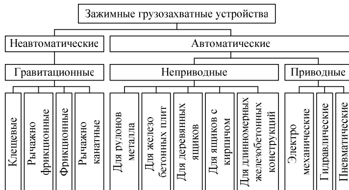
Рисунок 4.84 – Классификация зажимных грузозахватных устройств
