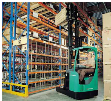
Рисунок 9.23 – Ричтрак (высокоподъемный штабелер с выдвигающейся кареткой)
