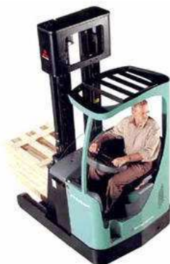
Рисунок 9.23 – Ричтрак (высокоподъемный штабелер с выдвигающейся кареткой)
