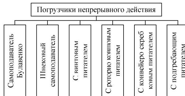
Рисунок 3.100 – Классификация погрузчиков автомобилей
