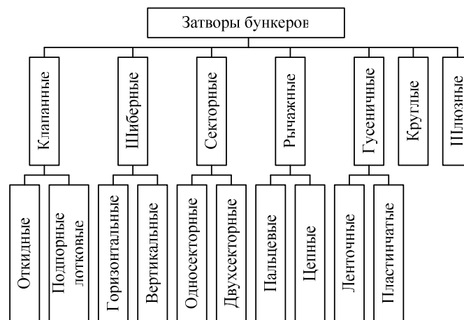
Рисунок 5.20 – Классификация затворов бункеров
