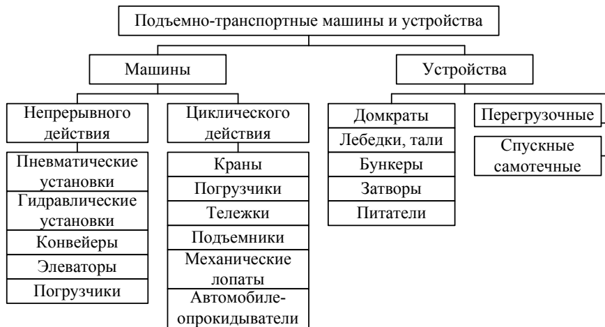
Рисунок 2.1 – Классификация подъемно-транспортных машин и устройств
