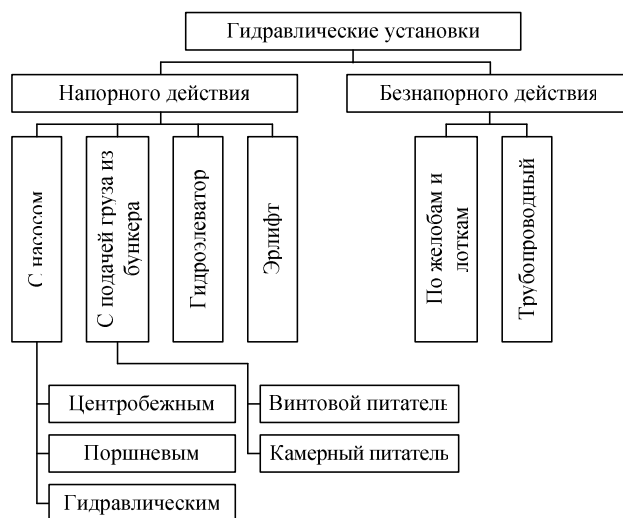
Рисунок 3.22 – Классификация гидравлических установок
