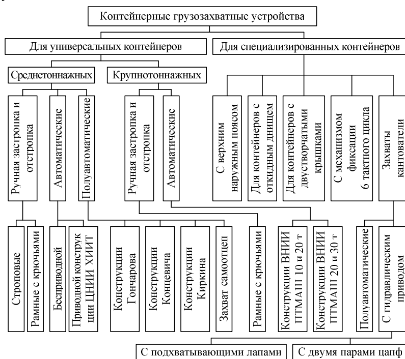
Рисунок 4.75 – Классификация грузозахватных устройств для контейнеров
