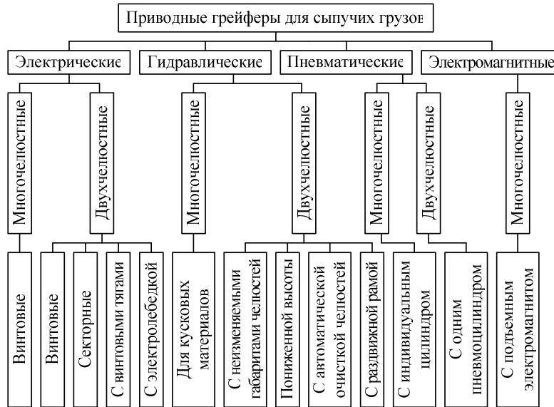
Рисунок 4.107 – Классификация приводных грейферов для сыпучих и кусковых грузов
