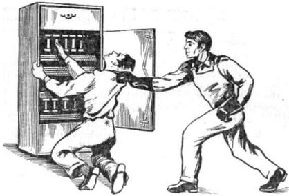
Рисунок 8.4 – Отделение пострадавшего от токоведущей части, находящейся под напряжением до 1000 В
