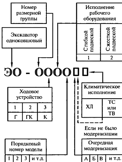
Рисунок 1.1 – Схема индексации универсальных одноковшовых экскаваторов
