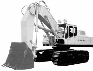
Рисунок 1.2 – Общий вид экскаватора с рабочим оборудованием типа прямая лопата
