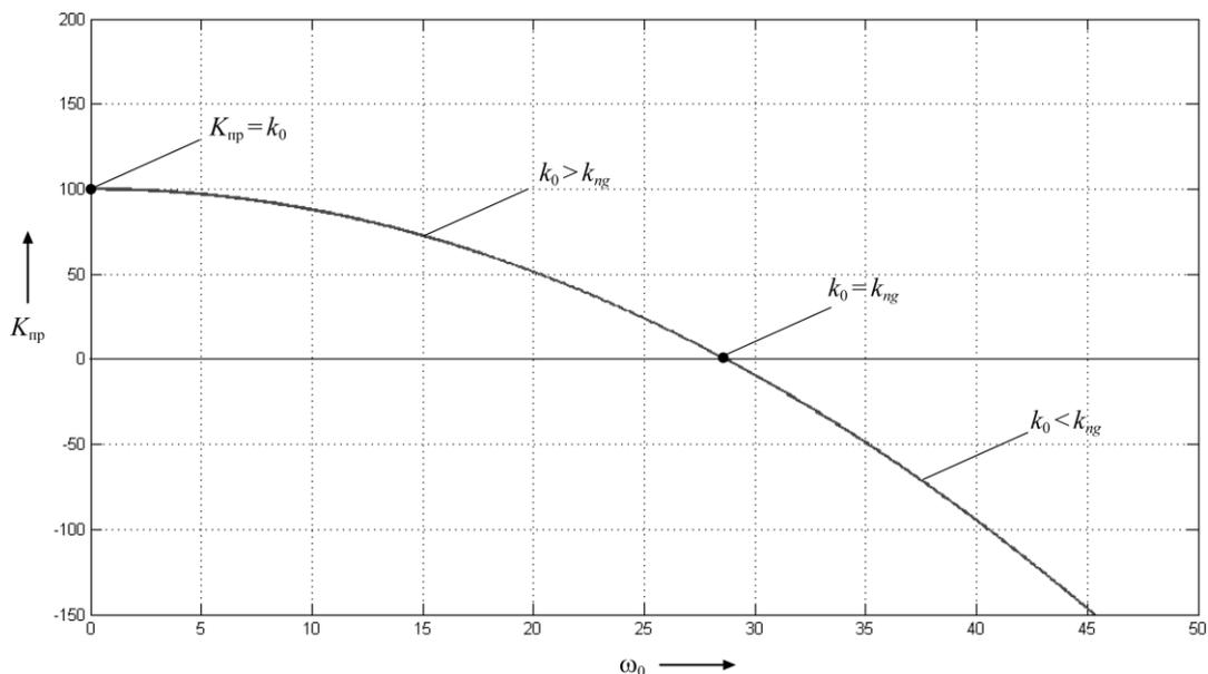
Рисунок 3 – График зависимости приведенной жесткости виброзащитной системы от угловой скорости  $K_{пр}(\omega_0)$
