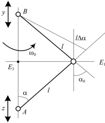
Рисунок 2 – Схема для определения смещений и скоростей движения  $m_1$
