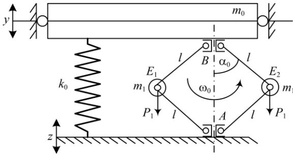
Рисунок 1 – Расчетная схема механической колебательной системы с упругим элементом  $k_0$  и пружиной с отрицательной жесткостью  $k_1$  в виде вращающегося двухзвенника
