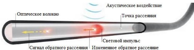
Рисунок 1.10 – Принцип действия технологии DAS: звуковые колебания и вибрации влекут за собой изменение интенсивности сигнала обратного рассеяния
