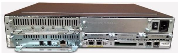
Рисунок 8.1 – Мультисервисный маршрутизатор доступа Cisco 3725
