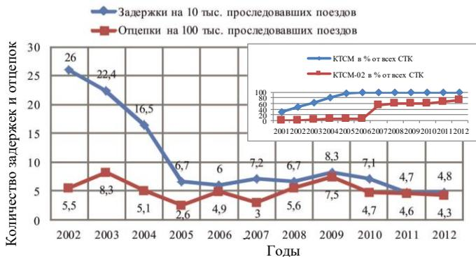
Рисунок 4.4 – График зависимости задержек и отцепок по показаниям средств теплового контроля
