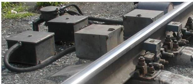
Рисунок 6.7 – Напольное оборудование КТСМ-02
