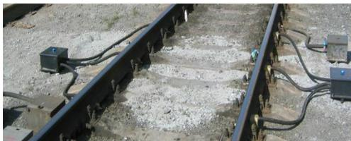
Рисунок 6.1 – Общий вид напольного оборудования КТСМ-К
