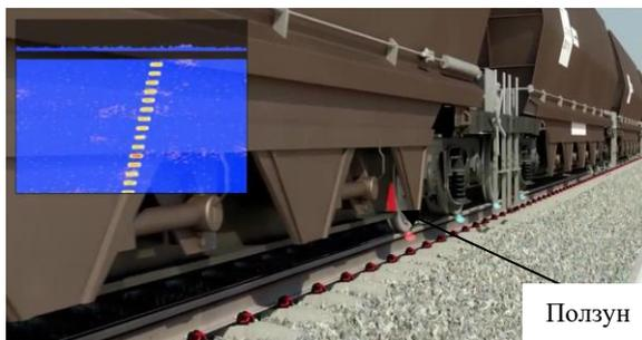
Рисунок 1.13 – Изображение ползуна на поверхности катания колеса (выделено красным цветом и стрелкой)
