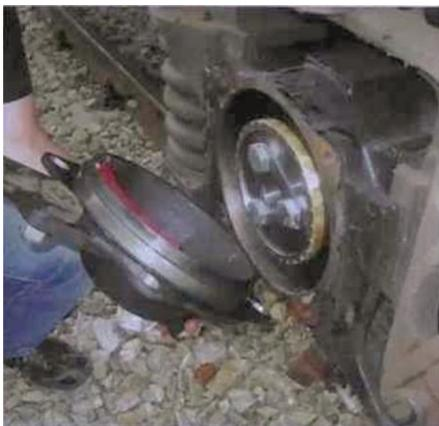
Рисунок 1.28 – Монтаж оборудования системы Waggon Tracker в буксовом узле
