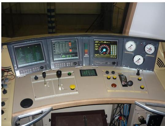
Рисунок 1.33 – Общий вид устройства отображения информации комплекса БЛОК на локомотиве 2ЭС10
