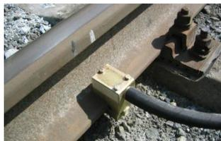
Рисунок 6.2 – Крепление вибродатчика КТСМ-К к подошве рельса
