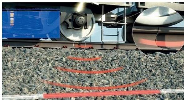
Рисунок 1.14 – Фиксация излома рельса под воздействием ползуна
