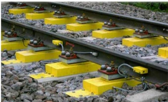
Рисунок 1.6 – Внешний вид диагностического оборудования системы Multirail WheelScan
