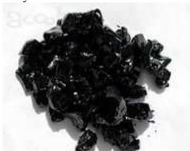
Битумы – это сложные смеси углеводородов и их неметаллических производных, т. е соединений углеводородов с серой, кислородом, азотом и некоторыми другими химическими элементами. Представляют собой жидкие, вязкие и твердые вещества коричнево-черного цвета. По происхождению битумы делятся на:
