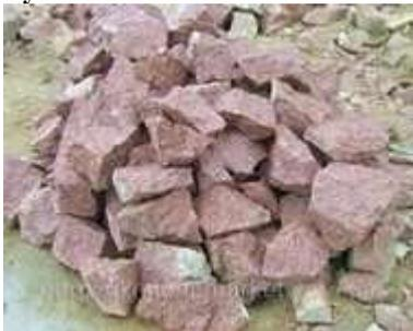
Бутовый камень получают из горных пород со средней плотностью свыше  $1800 \text{ кг/м}^3$ . Его применяют в соответствии со строительными нормами и правилами для фундаментов и стен зданий и сооружений, в качестве заполнителя для бутобетона при возведении бетонных и массивных железобетонных сооружений, для отмосток, а также при устройстве и ремонте автомобильных дорог.
