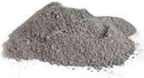
**Цемент** представляет собой тонкоразмолотый минеральный порошок, способный при смешении с водой образовывать пластичную массу, с течением времени затвердевающую в камневидное тело.
