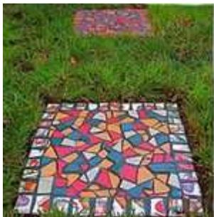
Плиты представляют большой класс декоративных облицовочных изделий с **мозаичной, брекчиевидной и орнаментной** поверхностью, изготовленных с использованием природного камня и неорганических или синтетических связующих и предназначенных для наружной и внутренней облицовки элементов зданий и сооружений. В зависимости от способа изготовления плиты делятся на три типа.
