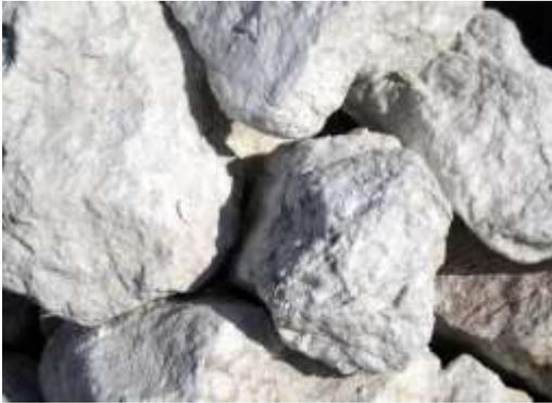
Гипсовые вяжущие вещества отличаются от всех известных минеральных вяжущих веществ быстрым твердением, хорошими формовочными свойствами и наибольшей экономичностью. Это позволяет сравнительно просто и в короткие сроки производить на их основе различные виды перспективных изделий для сборного строительства, характеризующихся сравнительно невысокой плотностью, достаточной прочностью, хорошими акустическими и теплофизическими свойствами.
