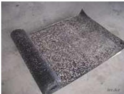
**Рулонные кровельные материалы** представляют собой полотнища, скатанные в рулоны. Рулонные материалы могут обеспечивать водонепроницаемость кровли даже при нулевых уклонах, а верхний предел допустимых ее уклонов неограничен. Рулонные кровельные материалы классифицируют по следующим основным признакам:
