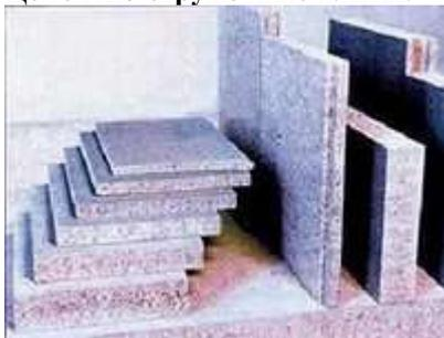
**Цементно-стружечные плиты** – это композиционный строительный материал, представляющий собой затвердевший цементный камень, хаотично армированный дробленой стружкой, толщина которой 0,2...0,3 мм, а длина — 10...30 мм.
