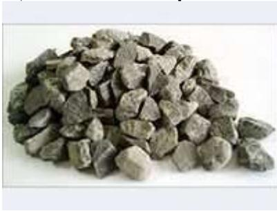
Предназначены для декоративной наружной и внутренней облицовки поверхности бетонных и железобетонных элементов зданий и сооружений, а также для производства декоративных плит на основе природного камня. Их получают путем дробления отходов, образующихся при добыче из массива горных пород блоков, отходов при производстве облицовочных плит и архитектурно-строительных изделий и специально разрабатываемых для этого горных пород.
