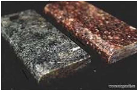
Плиты изготавливаются распиливанием блоков и предназначены для наружной и внутренней облицовки элементов зданий и сооружений.
