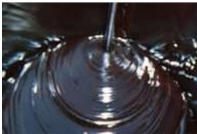
Деготь – это продукт сгущения (конденсации) летучих углеводородов и их неметаллических производных, образующихся при сухой перегонке твердого топлива и других органических веществ. Перегонка производится с целью получения кокса и газа из каменного угля, полукокса — из бурого угля, торфа и горючих сланцев, угля — из древесины, газа — из нефти.
