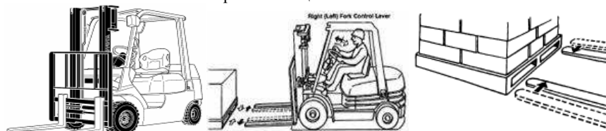
Рисунок 3.14 (начало) – Сменные грузозахватные устройства для погрузчиков
