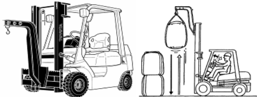
Рисунок 3.14 (окончание) – Сменные грузозахватные устройства для погрузчиков
