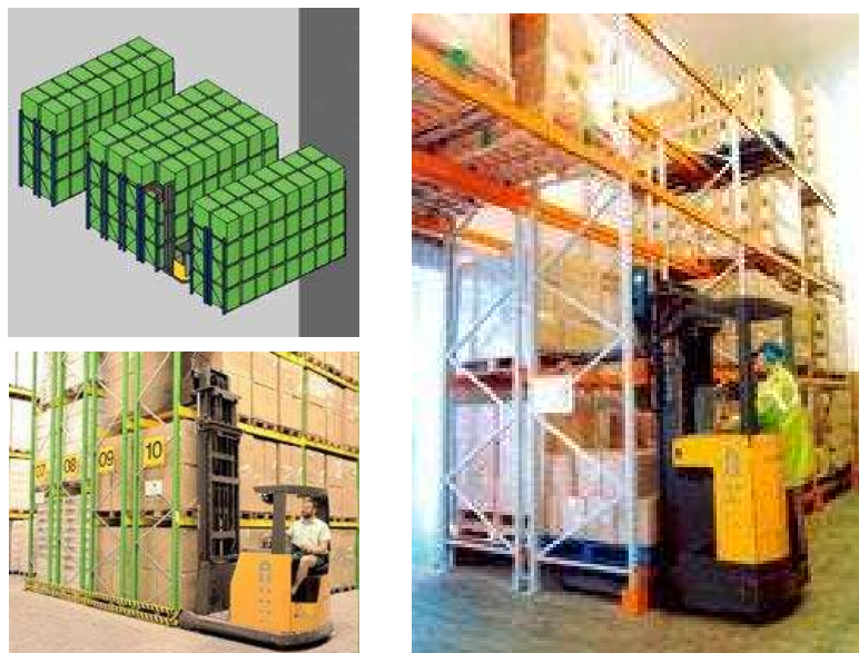
Рисунок 3.9 – Стеллажи двойной глубины
