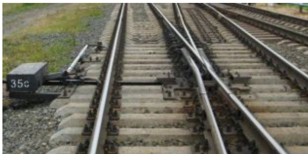
Рисунок 1.4 – Устройство стрелочного перевода с подвижным сердечником
