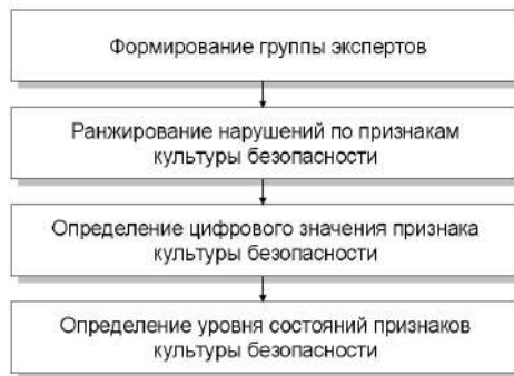
Рисунок 1 - Последовательность проведения оценки состояния признаков культуры безопасности
