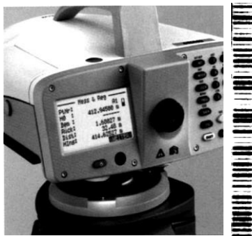
Рисунок 11.2 – Цифровой нивелир и штрихкодовая рейка
