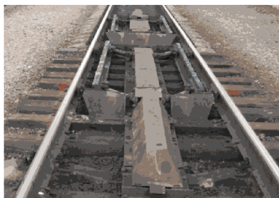
Рисунок 3.12 – Балочное устройство АСУЗР-65 для закрепления подвижного состава
