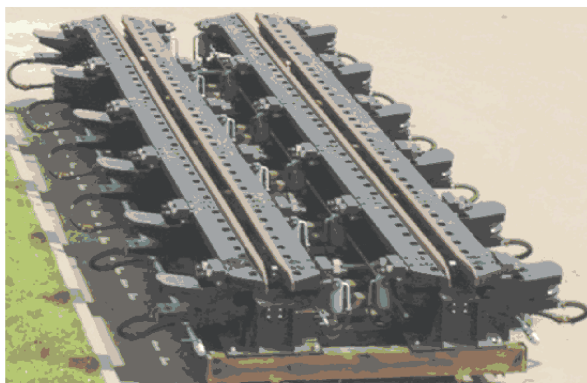
Рисунок В.2 – Общий вид двухрельсового вагонного замедлителя типа ЗВУМ 900-5-2
