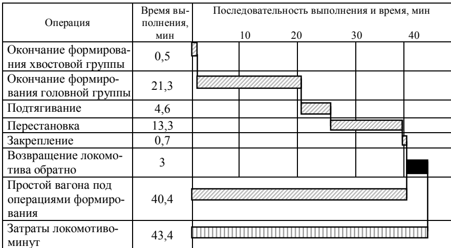
Рисунок 4.9 – Технологический график формирования двухгруппного поезда на вытяжном пути на станции К
