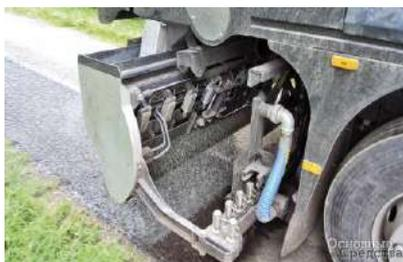
Рисунок 1 – Битумощебнераспределитель *CHIPSEALER A-R*:
