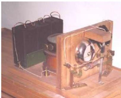
Рисунок 1 – Радиоприемник
