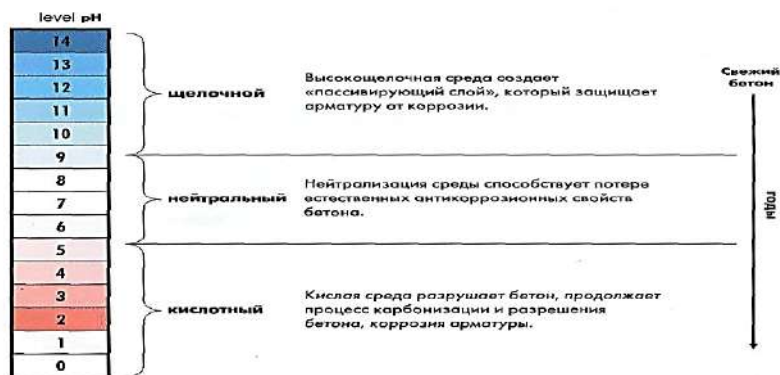
Рисунок 2 – Изменение щелочности бетона при воздействии агрессивной газовой среды
