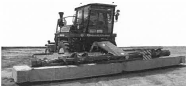
Рисунок 1 – Косилка-площилка навесная фронтальная КПН-6-Ф, агрегируемая с универсальным энергетическим средством УЭС-2-280А
