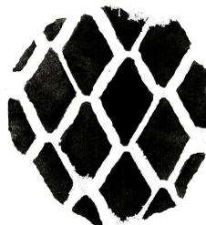
Рисунок 2 – Отпечаток рассматриваемого колеса при статическом контакте
